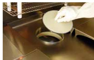
4. Beginnen Sie nun, das FIBO-Gehäuse unter dem Isolator zu demontieren.
