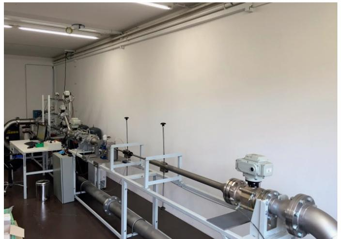
Abbildung 4: Kalibrierungsprüfstand für Gas-Durchflusssensoren bei Fa. CS-iTEC, Bild: Fa. gmp-experts GmbH
