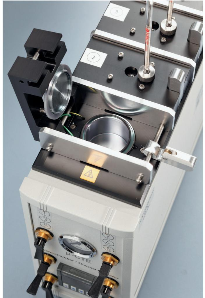
Abbildung 3: Mikro-Emissionskammer für Ausgangsuntersuchungen (Hersteller: Firma Markes)
