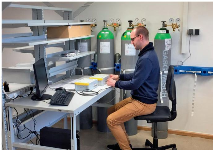
Abbildung 5: Kalibrierungsprüfstand für Ölsensoren bei Fa. CS-ITEC, Bild: Fa. gmp-experts GmbH
