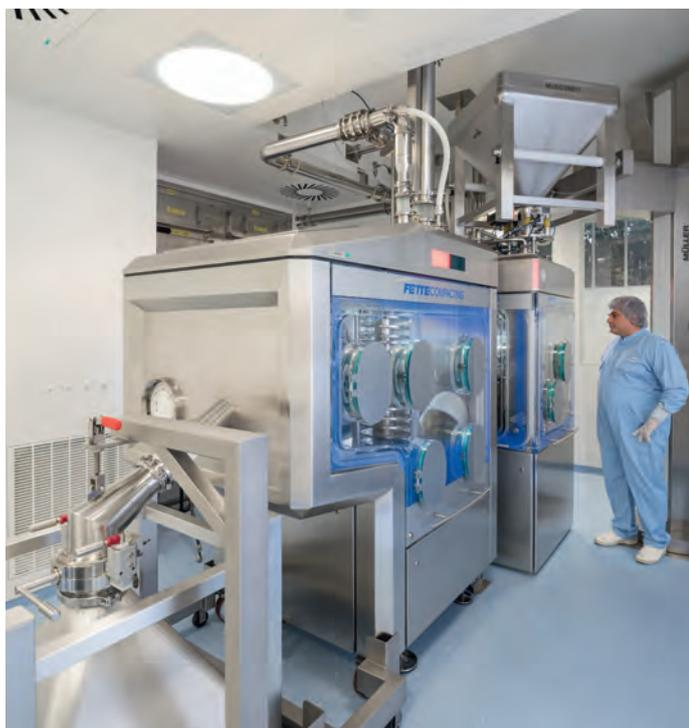
Tabletten werden in geschlossenen Anlagen hergestellt. In-Prozess-Kontrollen werden vollautomatisch in einem Isolator, der direkt an der Presse hängt, durchgeführt. (Foto Roche)
