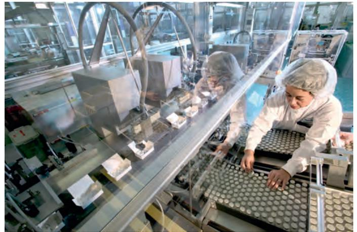
Abgefüllte Vials werden im Verpackungsbetrieb maschinell in aufgerichtete und verleimte Faltschachteln eingelegt. Die Faltschachteln sind länderspezifisch bedruckt und werden nach der kompletten Befüllung automatisch verschlossen und mit variablen Daten bedruckt. (Foto Roche)
