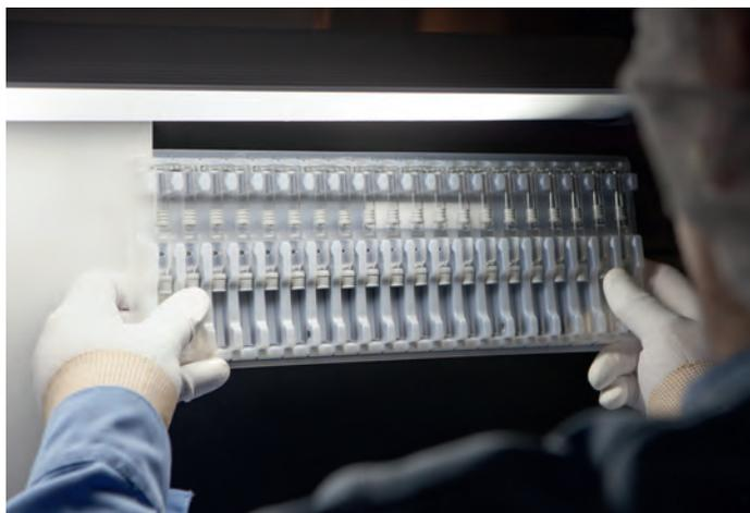
Nach der Abfüllung erfolgt eine hundertprozentige Inspektion jeder Einheit. Im Bild: manuelle Inspektion von Fertigspritzen. (Foto Roche)
