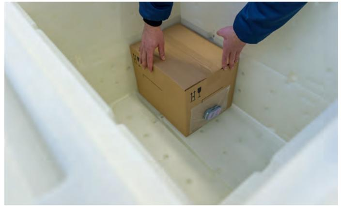
Die Medikamente werden entsprechend den Vorgaben unter Raum- oder Kühltemperaturbedingungen gelagert. Speziell entwickelte Transportverpackungen oder eingesetzte Transporthilfsmittel gewährleisten, dass die Kühlkette zwischen 2° und 8° C, aber auch für andere Temperaturbereiche wie zum Beispiel zwischen 15° und 25°, von der Fabrik bis ins Empfängerland eingehalten werden. (Foto Roche)
