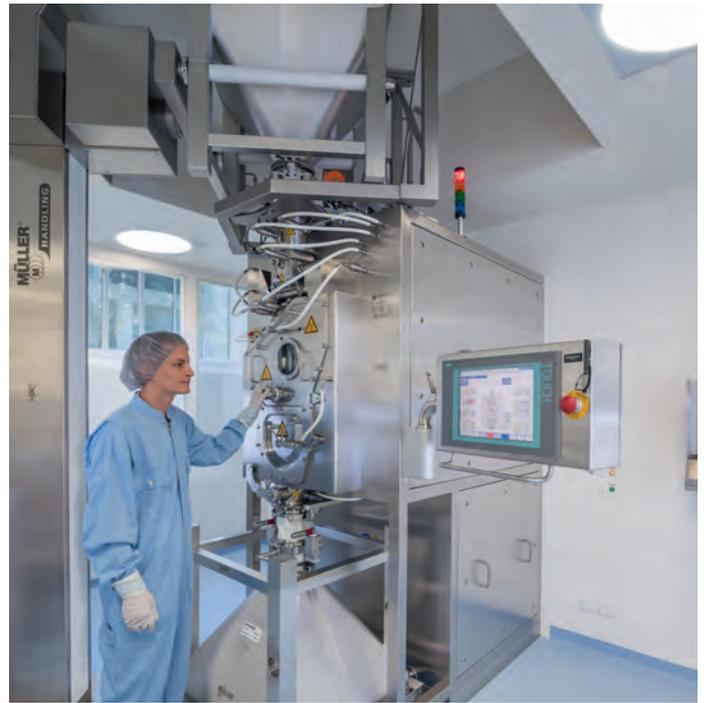
Für die Herstellung von Tabletten wird die Pulvermischung vorher granuliert. Dadurch erhält man ein gut fließendes Pulver, das sich auf den Hochleistungstablettenpressen gut weiterverarbeiten lässt. (Foto Roche)
