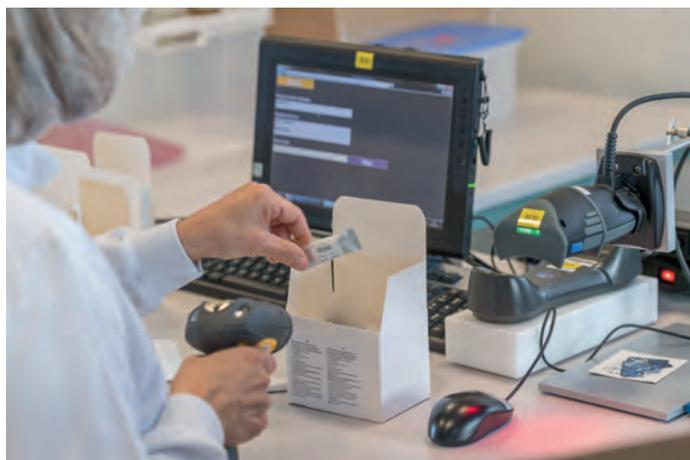
Mittels Barcode-Scanner werden die verschiedenen Verpackungsschritte überwacht und dokumentiert. In diesem Beispiel wird für eine Doppelblindstudie die Zuordnung der serialisierten, das heisst patientenspezifischen Medikation zum entsprechenden Kit, sichergestellt. Das Computersystem generiert gleichzeitig den notwendigen Report für die Freigabe durch die Qualitätskontrolle. (Foto Roche)
