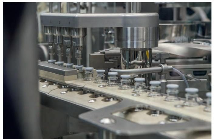
Die Produktlösung wird durch Abfüllmaschinen in Vials (hier im Bild) und Fertigspritzen abgefüllt. (Foto Roche)
