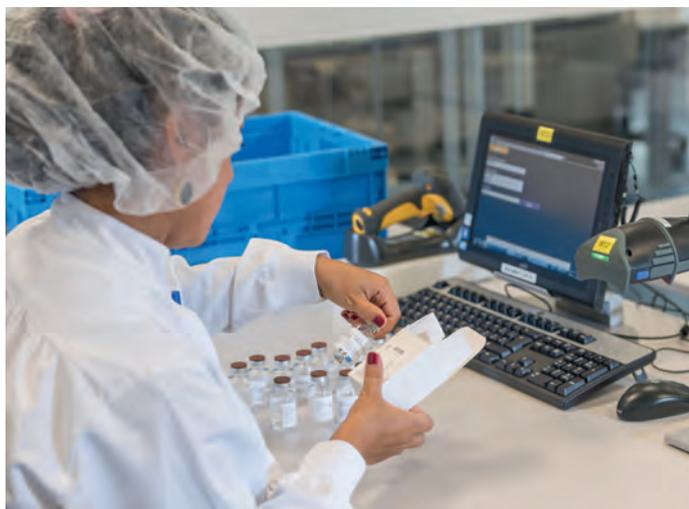
Die Qualitätskontrollen und die Inprozesskontrollen sind ein wichtiger Bestandteil des Verpackungsprozesses. So wird sichergestellt dass keine Fehler während der Verpackung entstanden sind. Hier wird die Druckqualität der Etiketten stichprobenweise überprüft. (Foto Roche)
