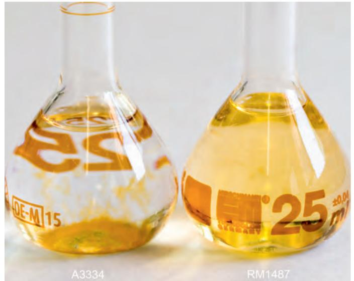
Abbildung 4c: Messlösung Untersuchungsmuster A3334 mit beobachtbarer Ausfällung verglichen mit Messlösung Referenzmaterial RM1487 ohne beobachtbare Ausfällung. (Bild: © Kantonsapothekeramt Bern)
