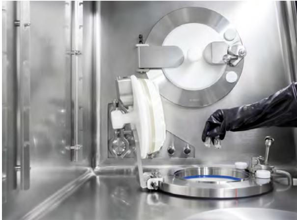
**Das Geringe DPTE®-Transfersystem**, bestehend aus dem DPTE®-Alpha Port und einer Beta-Komponente, gilt als das sicherste Verfahren für den bi-direktionalen Transfer in aseptischen oder toxischen Arbeitsbereichen ohne Containment- oder Sterilitätsverletzung.
